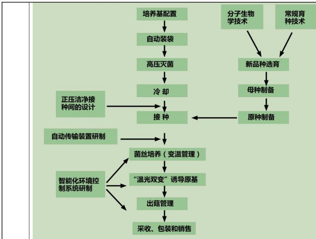
图 2-4 现有食用菌项目生产工艺流程图
