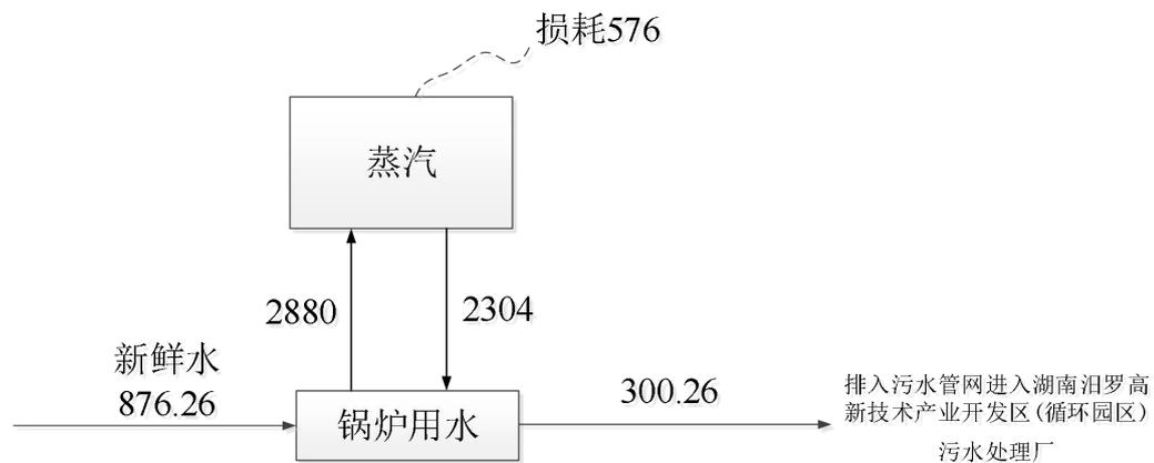
图 2-1 项目水平衡图（单位：m<sup>3</sup>/a）
