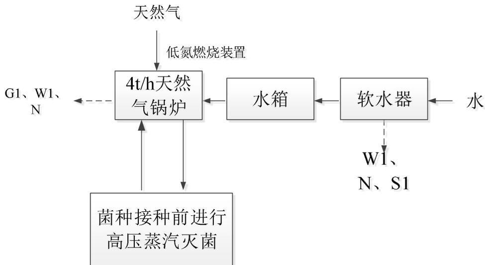
图 2-3 工艺流程及产污节点图
