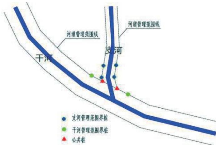
图 4.4.3-1 干支流交汇处无控制性建筑
