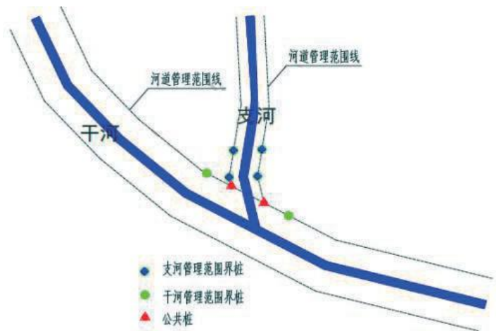
图 4.4.3-1 干支流交汇处无控制性建筑
