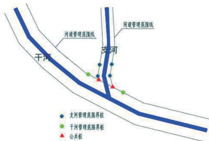
图4.4.3-1 干支流交汇处无控制性建筑
